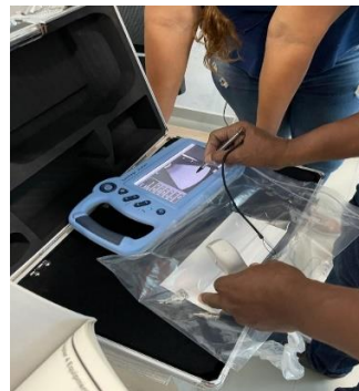
Ecógrafo portátil veterinario con sonda micro convexa
