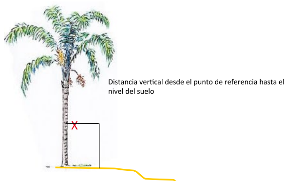
Figura 6. Esquema de medición de distancia vertical desde el punto de referencia hasta el nivel del suelo.
