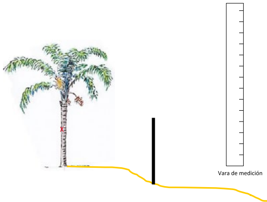
Figura 8. Esquema de ubicación de la vara de medición con escala de medida respecto al primer escalón de la inclinación.
