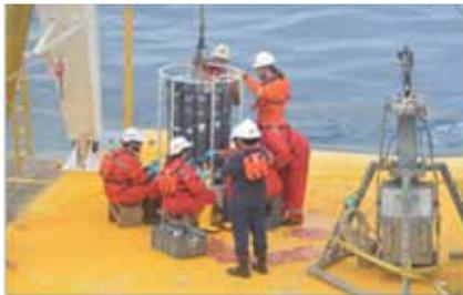
Toma de muestras de agua con botellas Niskin acopladas a la roseta oceanográfica a bordo del remolcador Don Saverio. Fugro.
