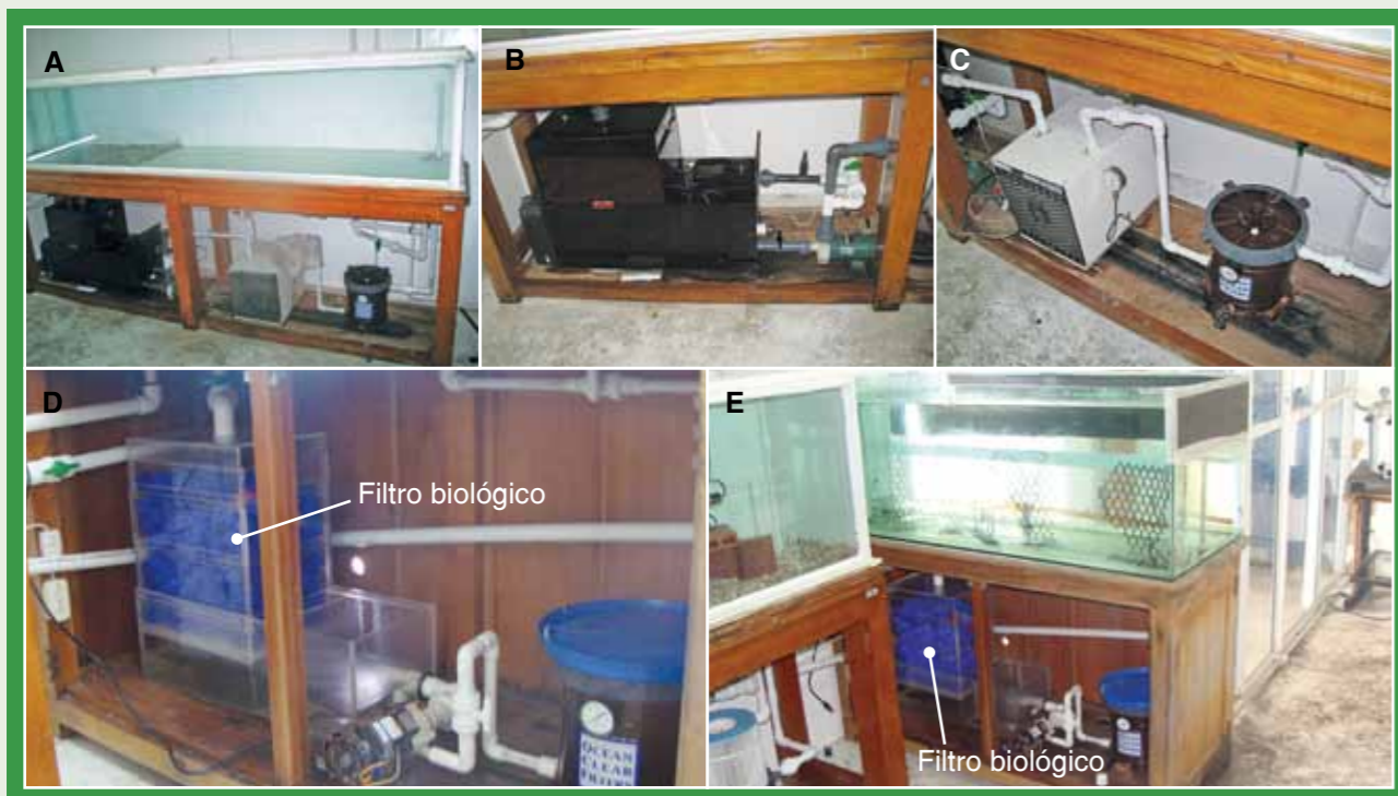
Figura 26. Montaje de acuarios para los Gramma loreto . Sistema para circulación del acuario de 900L (A), detalle del filtro biológico (B y D), chiller y filtro de cartucho (C) y sistema de circulación del acuario de 500L (E).
