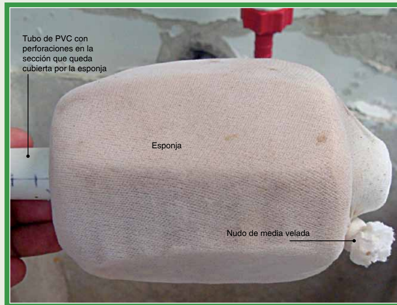
Figura 22. Sistemas de filtro para el desagüe de las incubadoras de 16L y acuarios de 25L (Pérez, 2011; Ospina-Salazar et al. , 2011).
