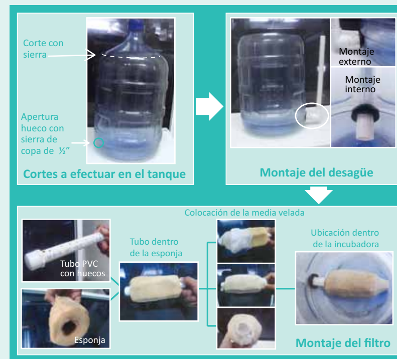
Figura 40. Elaboración de incubadoras de 16L para levante de crías de H. reidi .
