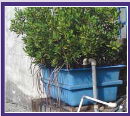
Figura 11. Biofiltro de mangle del LABBIP.
