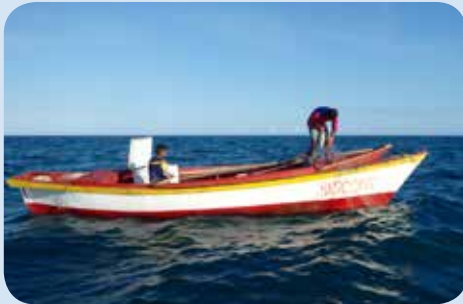
Lancha de madera, recubierta en fibra de vidrio, con motor interno de 16 HP. UEP de red de enmalle caritera.
