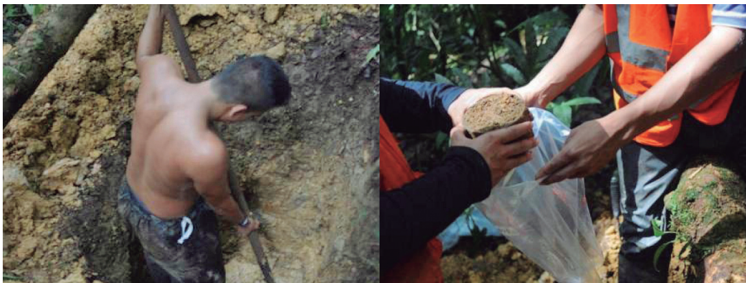
Figura 24. Establecimiento calicata para el muestreo de la densidad aparente del suelo: a) Establecimiento de la calicata; y b) colección y almacenamiento de las muestras de suelo.
