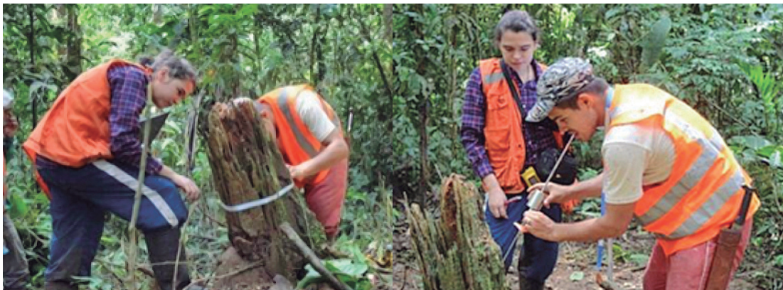
Figura 20. Muestreo de AMP: a) medición del diámetro; b) medición de la dureza con penetrómetro dinámico.
