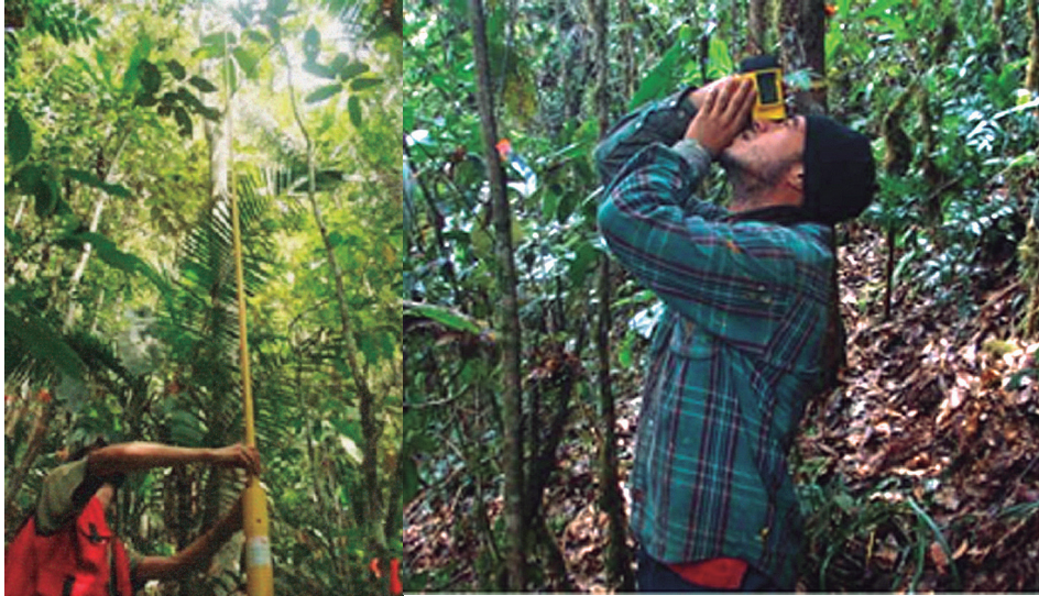
Figura 14. Instrumentos utilizados para la medición de la altura: a) vara extensible graduada; b) hipsómetro digital.
