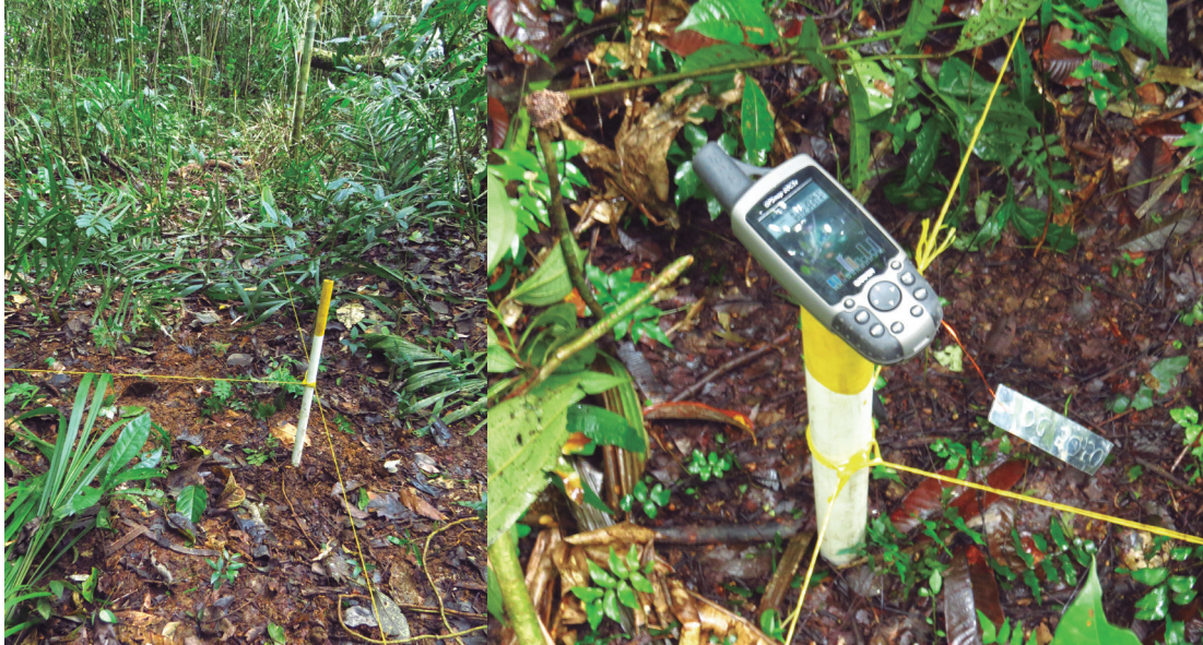
Figura 3. a) Delimitación de la parcela y cuadrantes con tubos y cuerda de polipropileno; y b) Georreferenciación de los vértices de la parcela.
