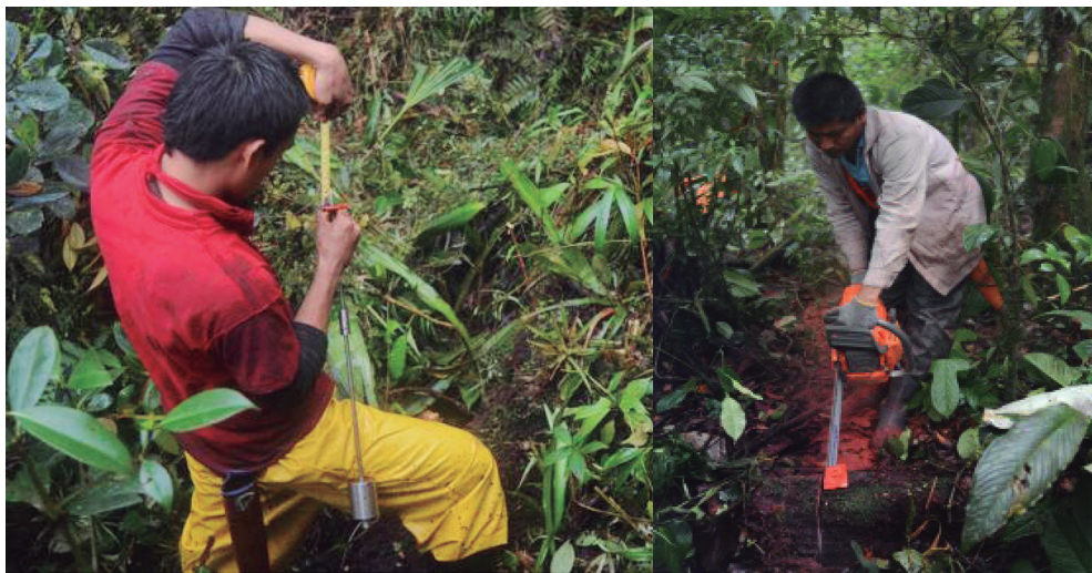
Figura 22. Muestreo de DGM; a) medición de la longitud de penetración del penetrómetro dinámico, y b) toma de muestras de DGM.
