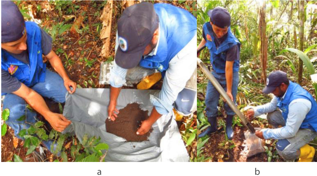
Figura 26. Muestreo de carbono orgánico en suelos; a) mezcla de todas las muestras obtenidas en 0-10 cm y 10-20 cm, y b) almacenamiento de las muestras en bolsas plásticas.
