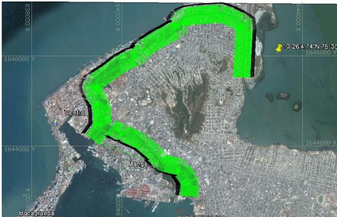
**Figura 3. Líneas planeadas para levantamiento batimétrico.**
