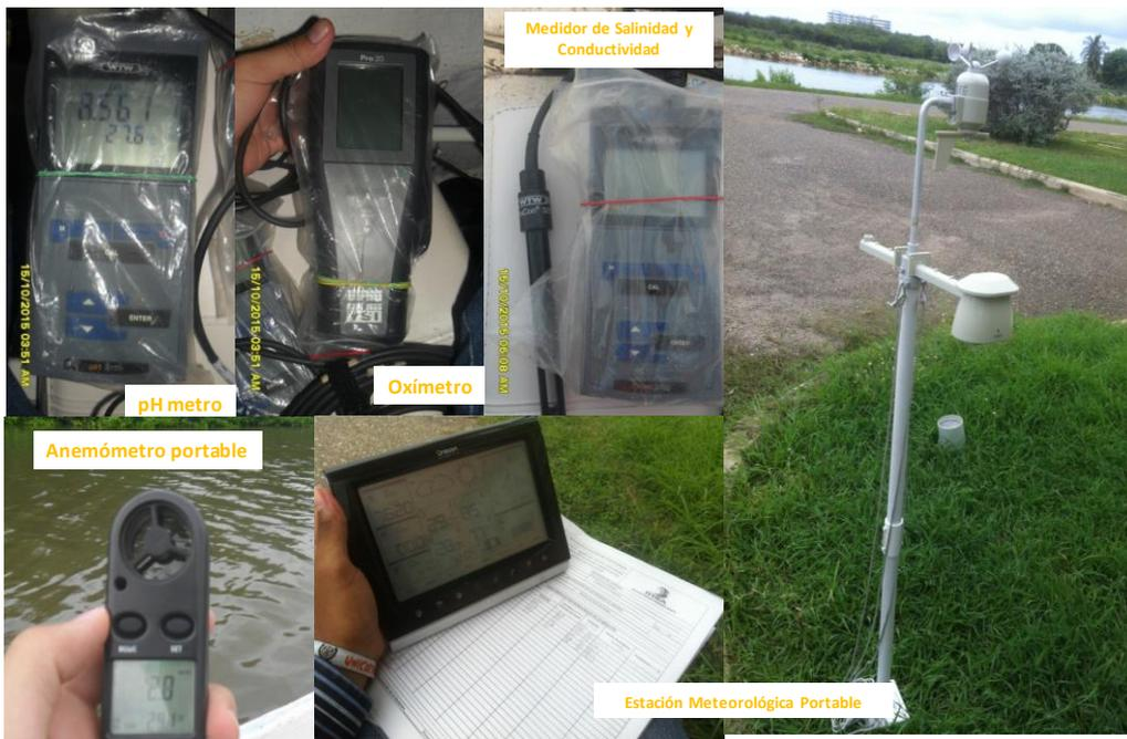
**Figura 9. Equipos utilizados durante las dos (2) campañas de monitoreo de los parámetros fisicoquímicos in situ**
