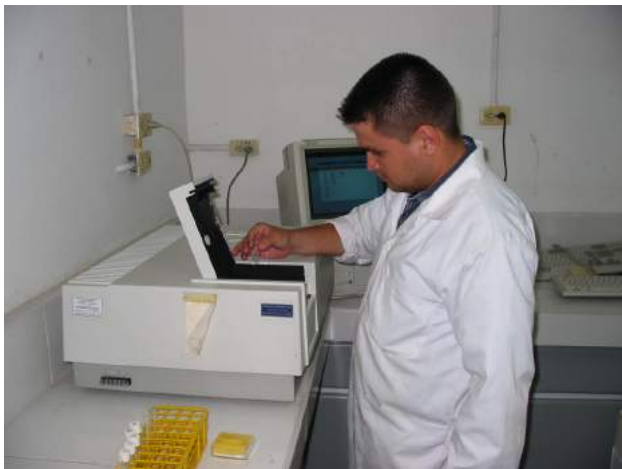
Spectrofluorómetro Shimadzu 5301-PC utilizado para la determinación de Hidrocarburos Aromáticos Totales (HAT)
