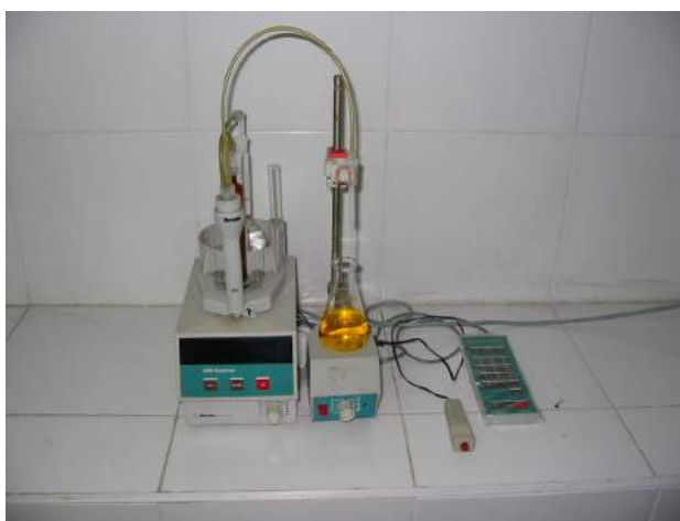
Bureta digital – automática utilizada para la determinación de oxígeno disuelto por el Método Winkler
