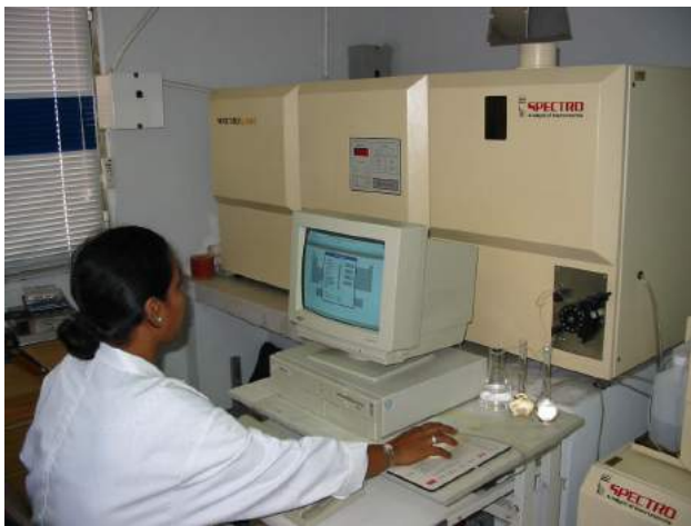
Equipo de emisión atómica ICP, Spectro Flame Modula, utilizado para la determinación de metales pesados
