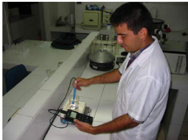
Equipo pHmetro WTW. Utilizado para medir el pH en laboratorio y en campo
