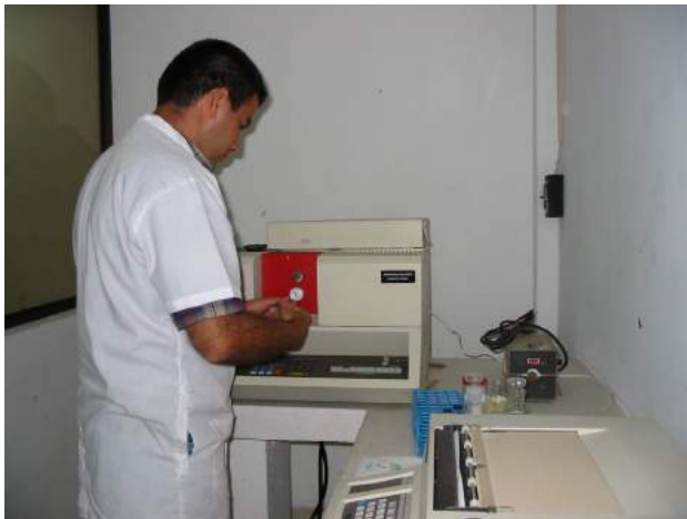
Cromatógrafo de gases Perkin – Elmer Sigma 300 con detector FID, utilizado para la identificación y cuantificación de hidrocarburos alifáticos y aromáticos
