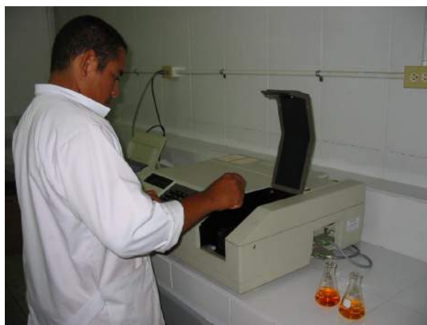
Espectrofotómetro UV-VIS Perkin Elmer-Lambda 12, utilizado en la determinación de nutrientes en muestras ambientales
