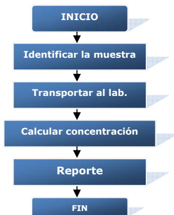
Figura 13. Pasos a realizar después del muestreo de SO 2 y NO x .
