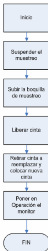
Figura 27. Proceso de revisión del analizador de material particulado PM 10
