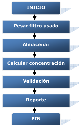
Figura 10. Pasos a realizar después del muestreo de material particulado.
