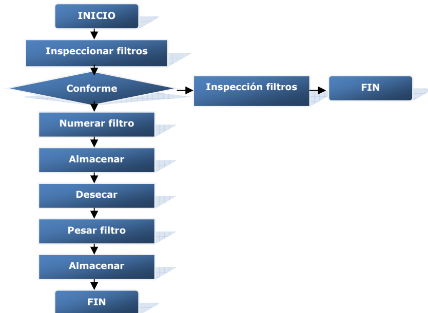
Figura 8. Pasos previos en la realización de muestreos de material particulado.
