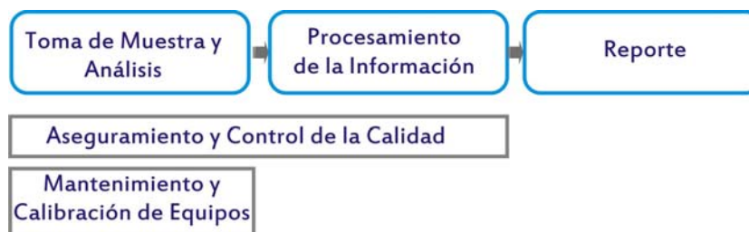
Figura 16. Proceso general de operación de un SVCA Automático.
