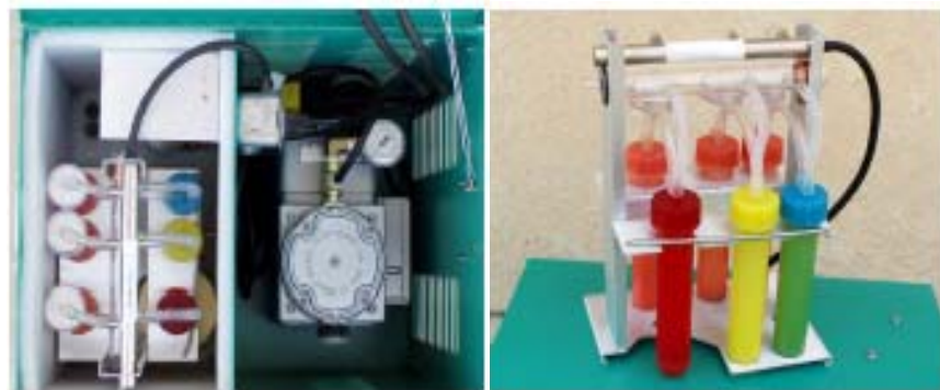
Figura 14. Equipo Muestreador de 3 Gases. Foto: Archivo K-2 INGENIERIA LTDA.
