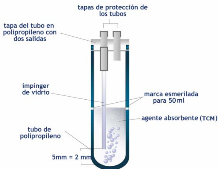
Figura 63. Absorbedor (toma de muestra de 24 horas) lleno y ensamblado para enviar.
