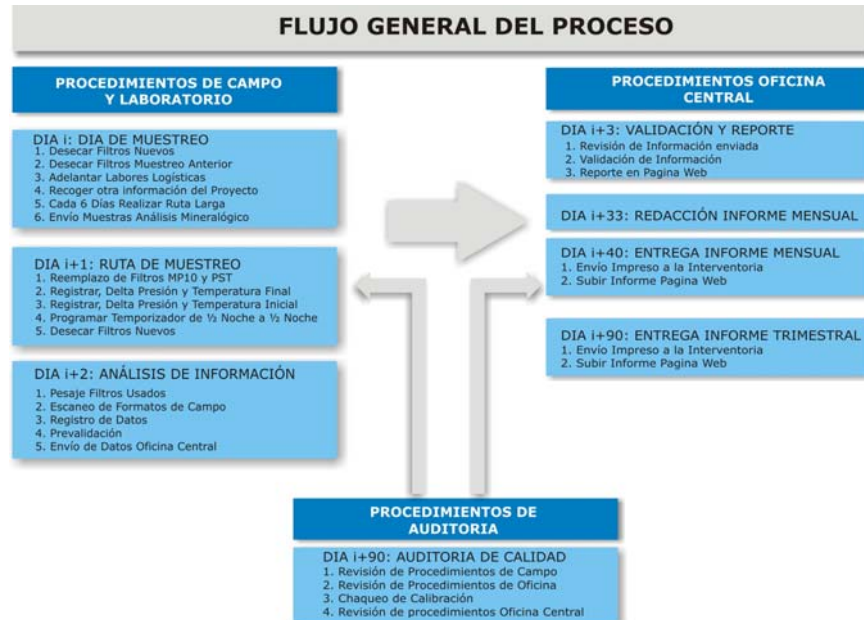
Figura 7. Ejemplo flujo de proceso de un SVCA Manual. (Tomado de Plan de Calidad Red de Calidad del Aire Zona Minera-CORPOCESAR)
