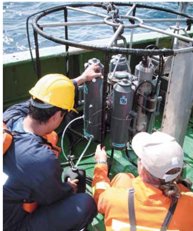
Figura 5. Sonda multiparámetros CTD (Conductividad, temperatura y profundidad) y roseta con botellas Niskin para toma de muestras de agua.
